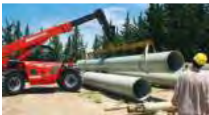
MHT 10120 avec palonnier de manutention* * Nous consulter
