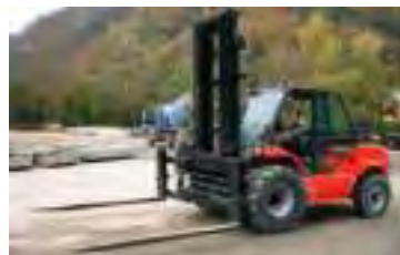
MC 70 avec positionneur de fourches
