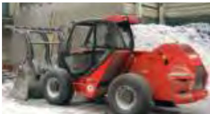
MHT avec godet grappin pour le chargement
