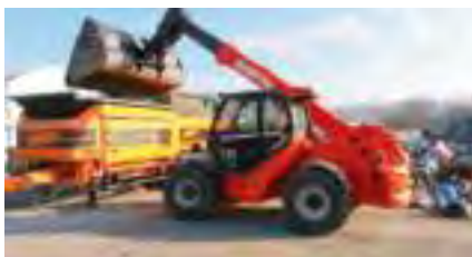
MHT : alimentation de trémie
