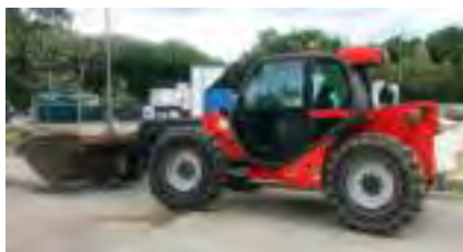
MLT 735 120 avec pneus alvéolés
