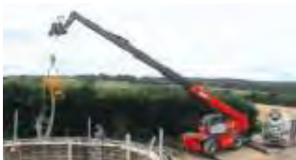
MRT 3050 avec treuil construction de STEP
